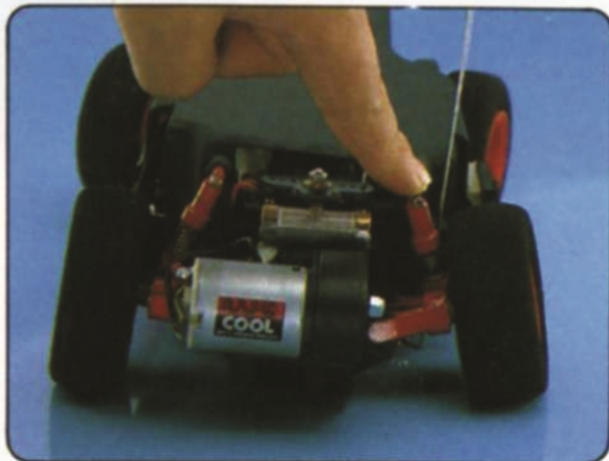
▲スイングアームとコイルスプリング。ストローク充分。強力RC280Sモーター付。
