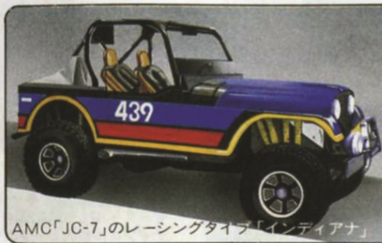
最低地上高50ミリ、驚異的な大ストロークサス。オイルダンパー4基標準装備。
